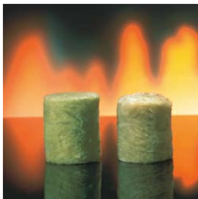
Po lewej, próbka wełny kamiennej przed badaniem niepalności, po prawej - po badaniu.
